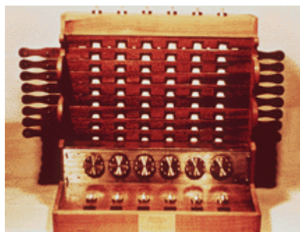
Orologio calcolatore di W. Schickard
