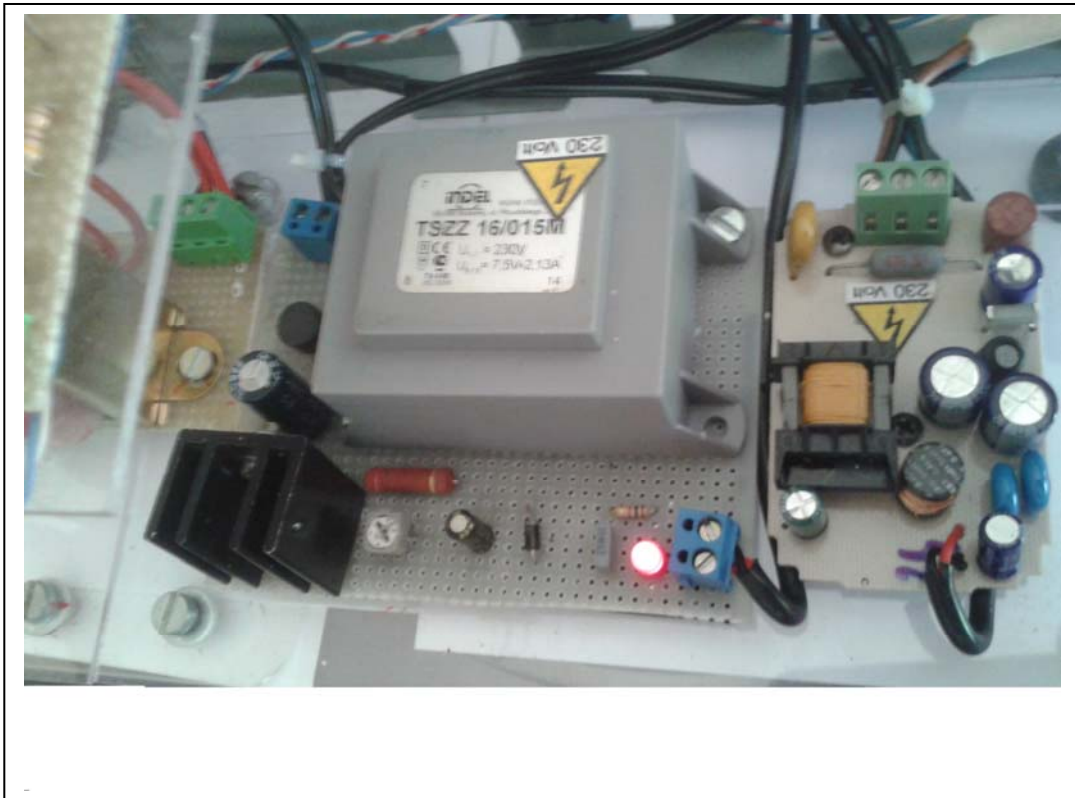
Alimentatore motore passo passo e alimentatore scheda PIC
